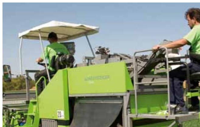
производится с помощью ленточного транспортера с гидравлическим приводом. Бесшовная обшивка емкости системы взвешивания обеспечивает беспрепятственное поступление в нее собранного материала и защиту процесса взвешивания от воздействия ветра.
