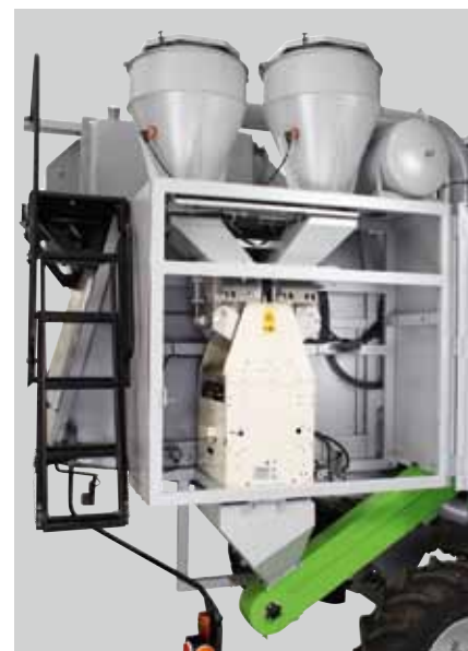
Два приемных бункера открываются и урожай поступает в бункер для взвешивания
