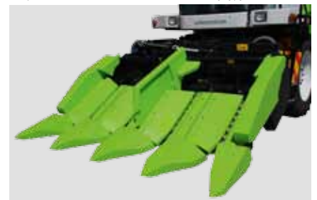
Гидравлически складываемая жатка для кукурузы
