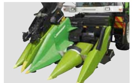
Гидравлически складываемая жатка для кукурузы
