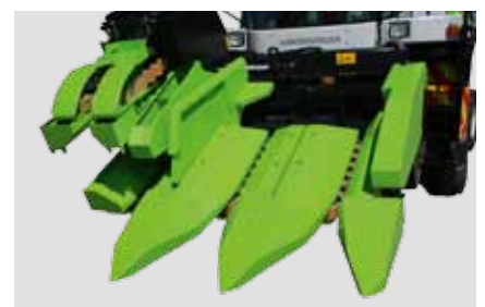
Гидравлически складываемая ручьевая жатка
