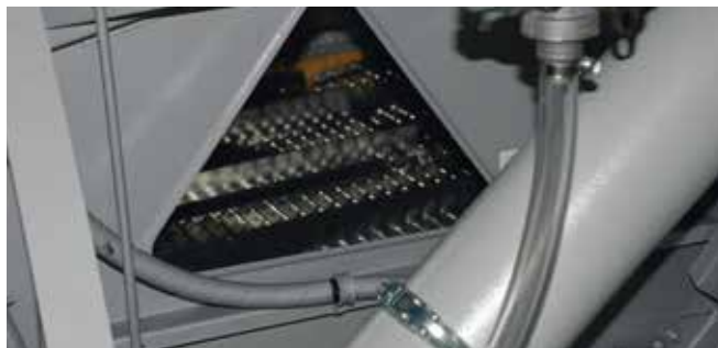
Отверстие для чистки молотильного аппарата
