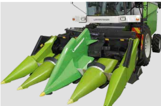
Гидравлически складываемая жатка для кукурузы
