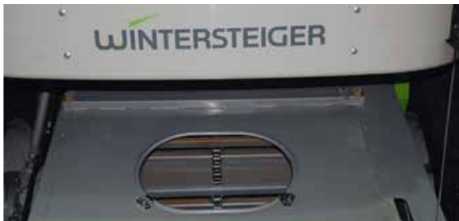
Отверстие для чистки наклонной камеры
