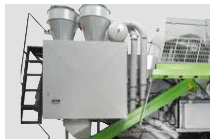
Двойной пневматический механизм подачи зерна
