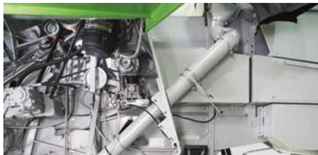
Пневматический механизм подачи зерна
