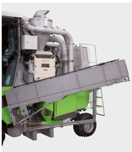
Подъем ленточного транспортера для проб и его поворот на 90°
