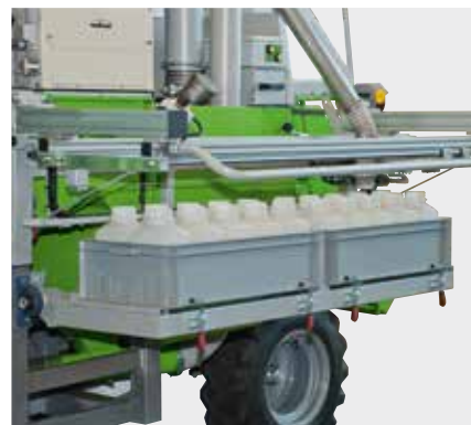
Устройство затаривания в контейнеры на салазках
