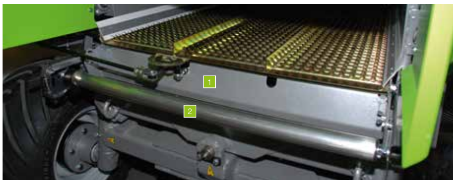
1 Электропривод пластинчатого сита 2 Датчик потерь зерна
