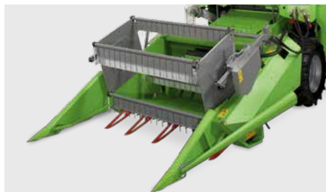
Жатка с наклонной камерой и цепным транспортером
