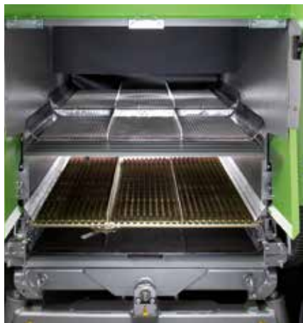
Плоскорешетный соломотряс и очистительные сита
