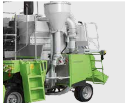
Система затаривания семян в мешки
