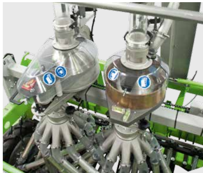
Конический и конический ячейковый дозаторы
