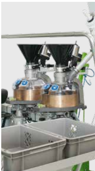
Два конических ячейковых дозатора и непрерывный посев
